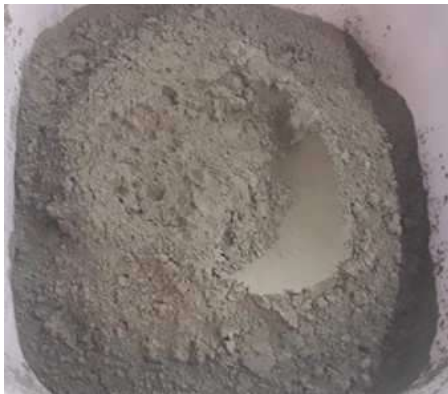
Cimento Portland + Cinzas volantes (Ativação Alcalina)
