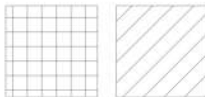
Figura 8 – Marcação de pavimentos e coberturas, respetivamente
