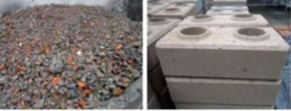
Aproveitamento de RCD para o fabrico de blocos
