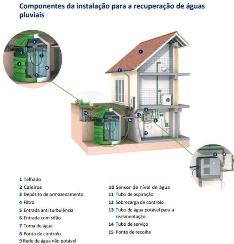
Figura 2.8 - Sistema de aproveitamento de água pluvial
