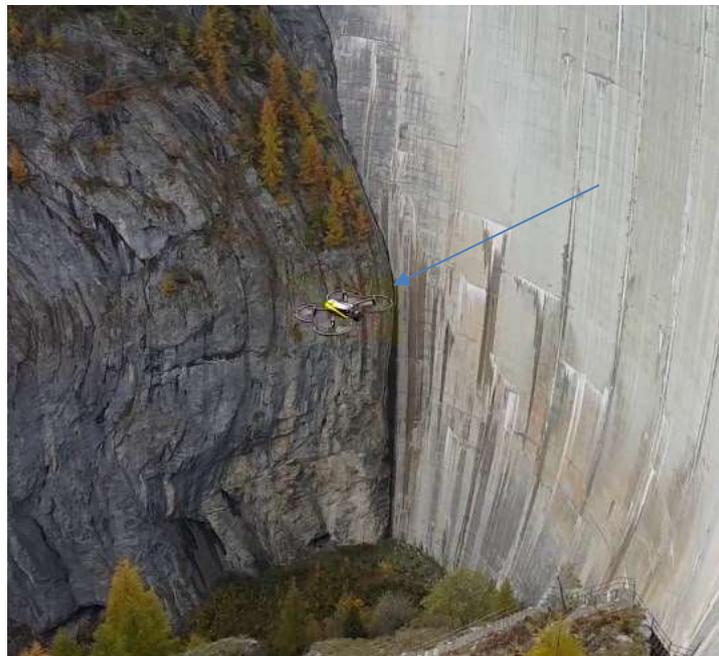
Figura 6.52 - Utilização de drones para inspeção de barragens
