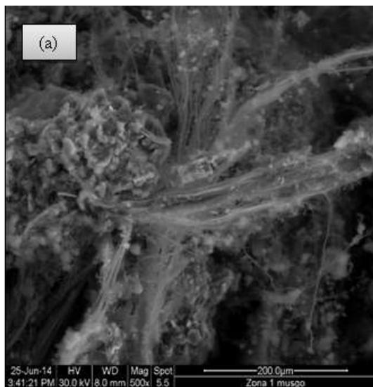
Figura 6.22 - Fibra de Actinolite com ampliação de 500X
