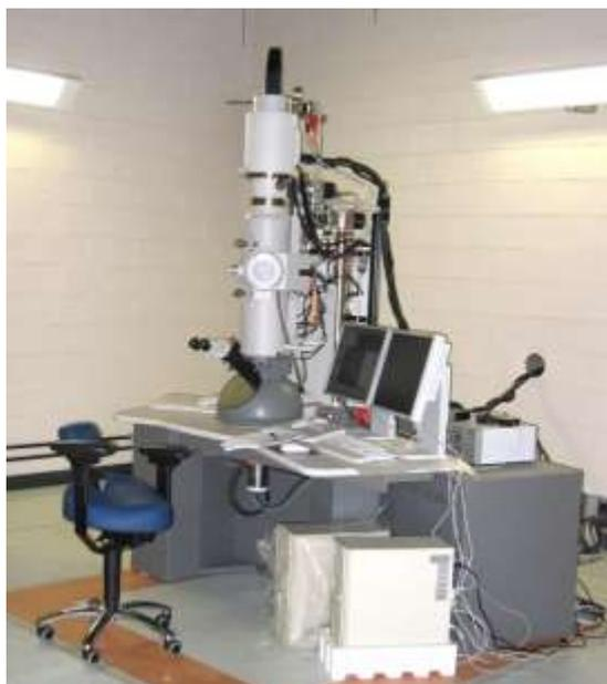
Figura 6.19 - Aparelho de Microscopia Eletrónica de Transmissão
