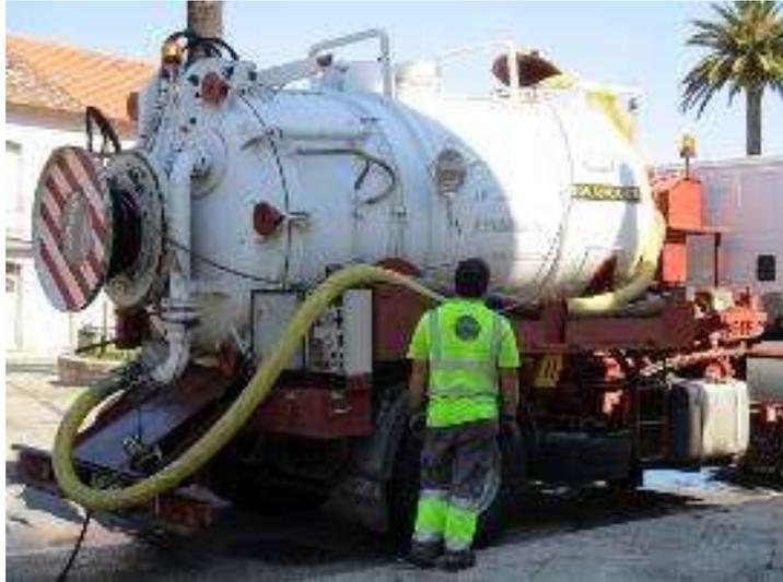
Figura 6.58 - Equipamento hidrodinâmico de alta pressão
