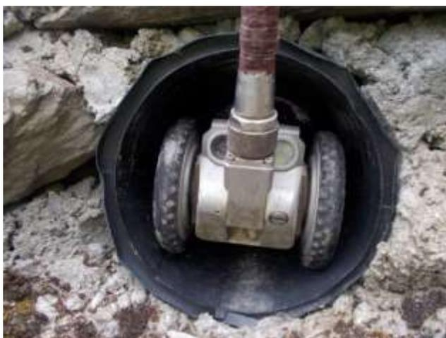
Figura 6.56 - Inspeção das passagens hidráulicas com recurso a robôs
