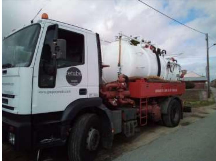
Figura 6.60 - Equipamento de limpeza/desobstrução Iveco
