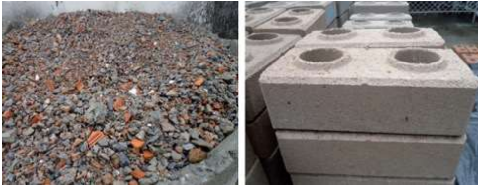
Figura 3.11 - Aproveitamento de RCD para o fabrico de blocos
