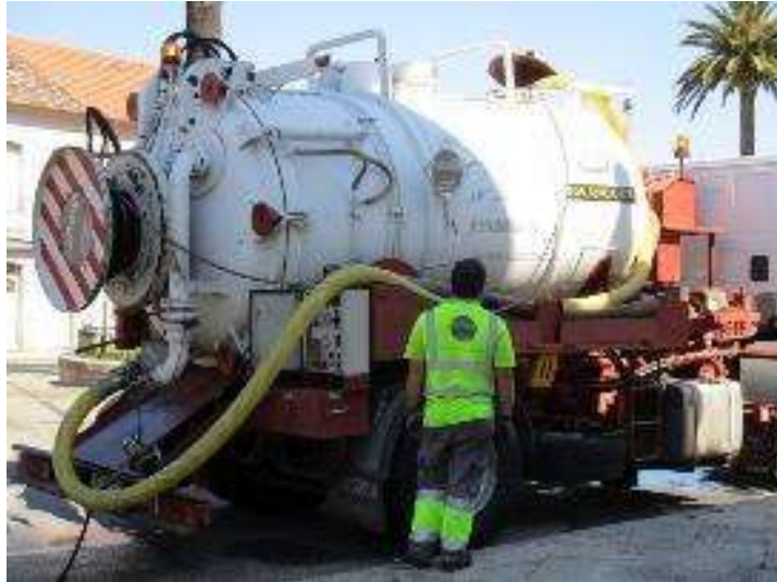
Figura 6.58 - Equipamento hidrodinâmico de alta pressão Fonte - Retube soluções tecnológicas
