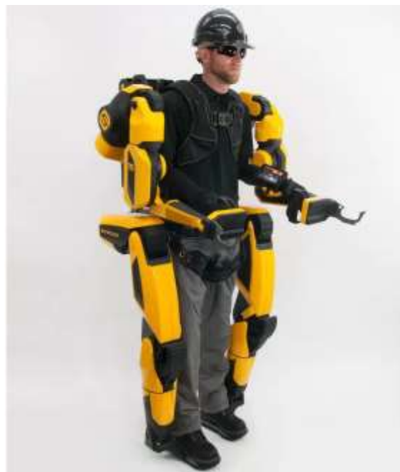
Figura 4.20 – Exoesqueleto disponível para a indústria de construção no Canadá
