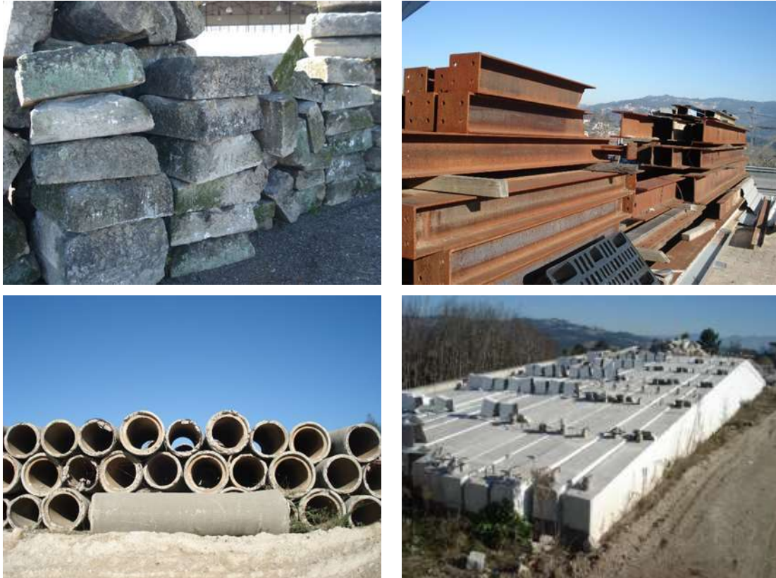
Figura 2.11 - Exemplo de materiais de construção provenientes da desconstrução de algumas obras e com grande potencial de reutilização
