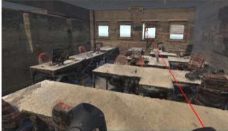
Figura 4.32 - Integração de nuvens de pontos capturadas por laser scanner numa interface imersiva
