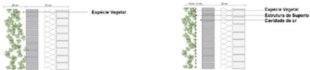
Figura 2.6 - Fachada verde direta (à esquerda) e indireta (direita)
