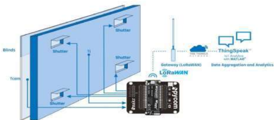
Figure 2.25 - Sistema de controlo e automação da parede de Trombe com transmissão de dados via LoRaWAN
