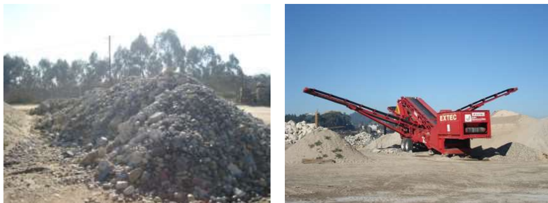
Figura 2.12 - Exemplo de agregados provenientes de algumas obras, triados e com grande potencial de reciclagem
