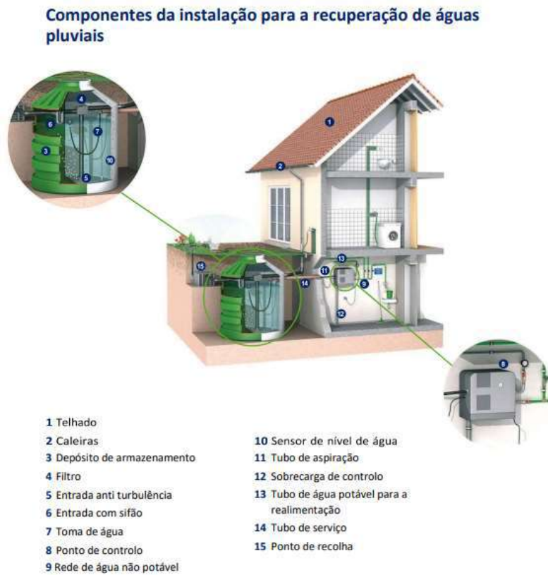
Figura 2.8 - Sistema de aproveitamento de água pluvial
