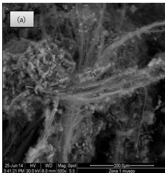
Figura 6.22 - Fibra de Actinolite com ampliação de 500X
