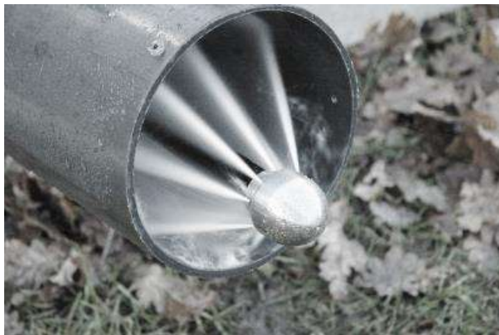
Figura 6.59 - Mangueira e ponteira de alta pressão Fonte - Retube soluções tecnológicas
