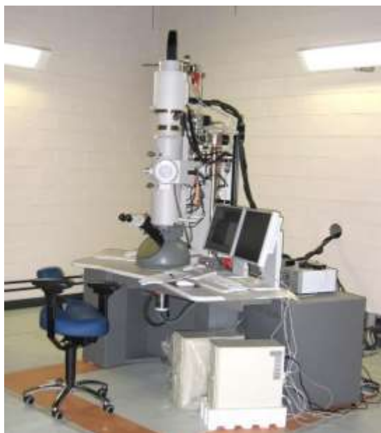
Figura 6.19 - Aparelho de Microscopia Eletrónica de Transmissão
