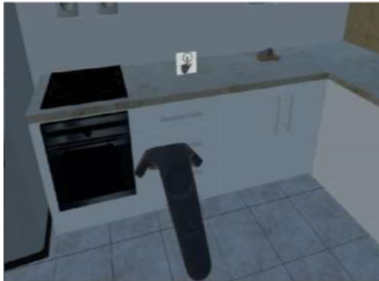
Figura 4.27 - Ambiente imersivo para revisão de modelo BIM Fonte - Cruz, T. (2018)
