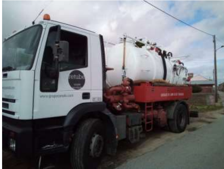
Figura 6.60 - Equipamento de limpeza/desobstrução Iveco Fonte - Retube soluções tecnológicas
