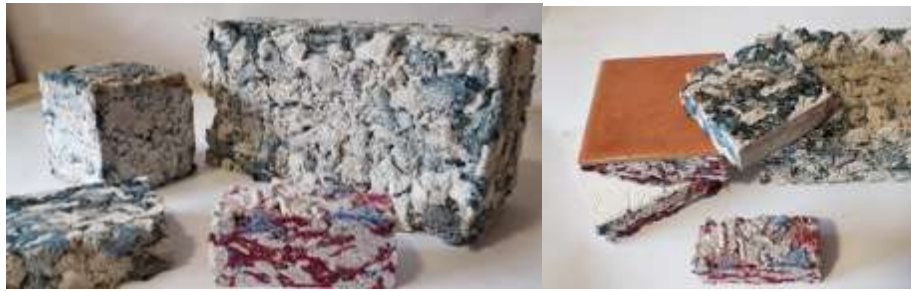
Figura 3.14 - Incorporação de resíduos têxteis em elementos de construção leve
