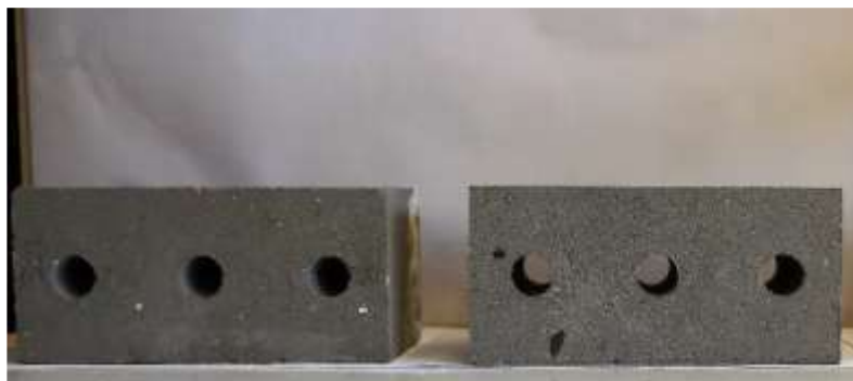
Figura 3.12 - Blocos de resíduos comprimidos com diferentes percentagens de resíduos de construção e de poliuretano
