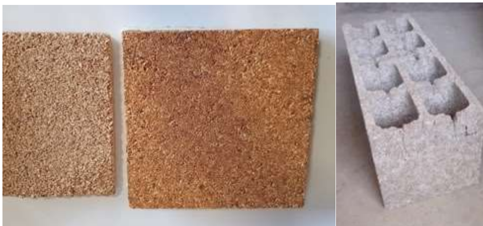
Figura 3.16 - Incorporação de granulado de carolo de espiga de milho na produção de placas e blocos de betão leve
